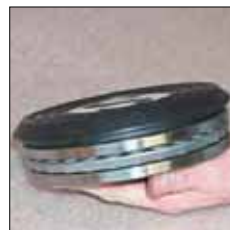
Rodamiento de bolas para la placa giratoria
